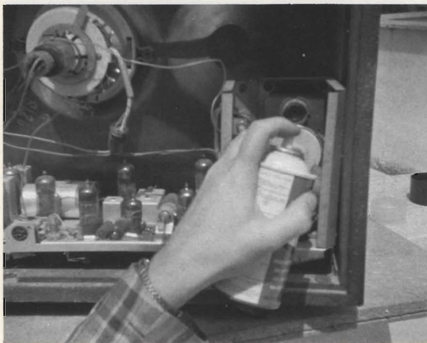
Fig. 7 - Lo zoccolo della eventuale rettificatrice EHT deve essere ben ripulito impiegando un apposito spray.
