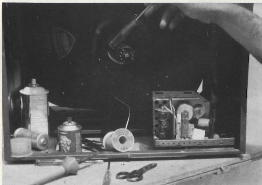
Fig. 5 - Ecco una prova da non fare: non si deve mai battere sul collo del tubo, dove il vetro è sottile; per eventuali verifiche della microfonicità, i colpetti saranno assestati sul «cono», assai più robusto.
