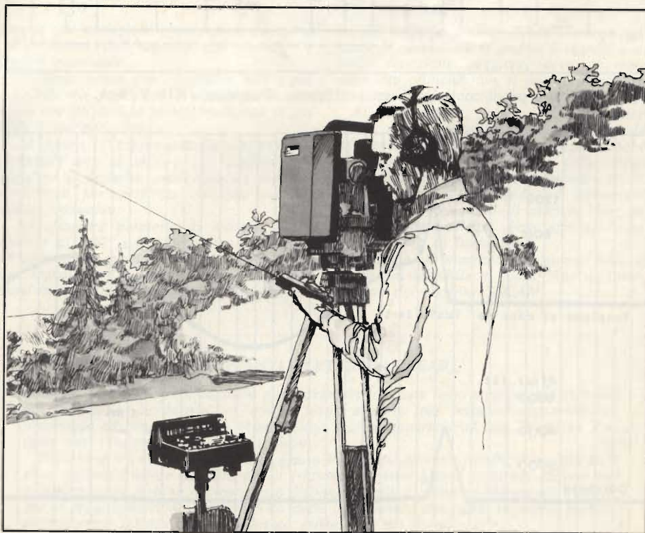
Fig. 6 - Uso pratico del complesso per geodimetria a laser AGA 710 più Geodat.
